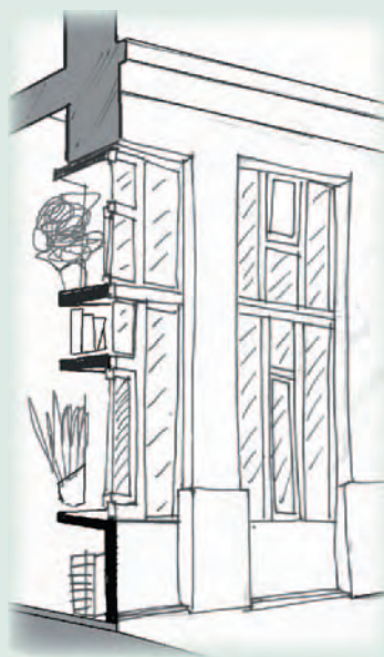
Les menuiseries se prolongent par des cadres épais formant étagères. Des objets domestiques sont visibles de l'extérieur.
