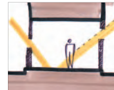
éclairage insuffisant: menuiseries de petite taille / rue sombre
